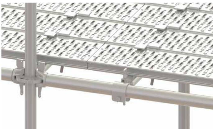
**2. 使用扣杆頭 (Transom Clamp) 與橫杆組合形成橫樑托架將扣杆與橫杆合理組合構成橫樑托架 (Ransom)：**作為踏板承重基架，安裝過程中需仔細檢查扣杆與橫杆的連接狀況，確保托架結構穩固，能承受腳手架踏板自重和作業人員動態荷載，為踏板提供堅實的支撐基礎。
