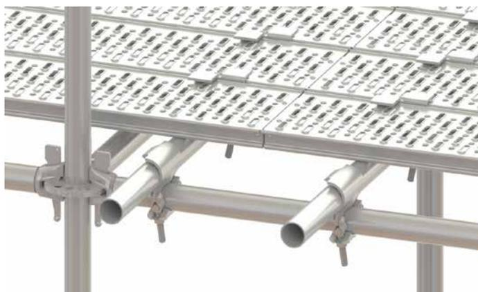
**1. 採用豬耳扣件 (putlog coupler) 將鋼管與橫杆進行固定作為踏板承重基架：**選用規格匹配的鋼管水準放置在橫杆上，採用豬耳扣件 (putlog coupler) 將鋼管與橫杆鎖骨，形成踏板承重基架，必須確保扣件達到安全扭矩值，消除使用中的鬆動 / 位移風險，保障踏板安裝後的穩定性。
