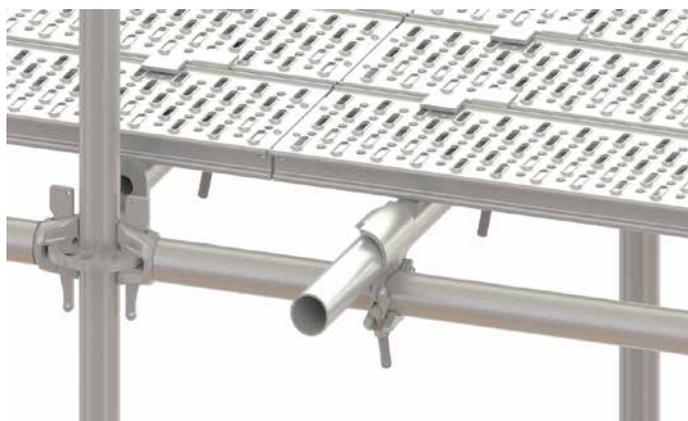
**3. 立杆位置與其他位置差異化安裝：**在立杆所在位置，採用專門設計的橫杆來代替普通橫杆，以增強關鍵部位的承載能力和結構穩定性；而在其他非立杆位置，則按照第一種方式，使用豬耳扣件 (putlog coupler) 將鋼管固定到橫杆上作為踏板承重基架。在整個安裝過程中，需嚴格把控不同位置的安裝細節，確保腳手架各部分連接牢固，受力均勻，滿足安全作業要求。
