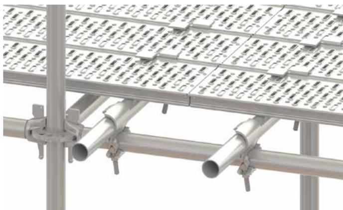
**1. 采用猪耳扣件 (putlog coupler) 将钢管与横杆进行固定作为踏板承重基架：**选用规格匹配的钢管水平放置在横杆上，采用猪耳扣件 (putlog coupler) 将钢管与横杆锁紧，形成踏板承重基架，必须确保扣件达到安全扭矩值，消除使用中的松动 / 位移风险，保障踏板安装后的稳定性。
