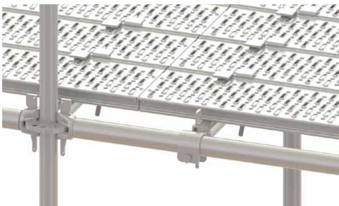
**2. 使用扣杆头 (Transom Clamp) 与横杆组合形成横梁托架**将扣杆与横杆合理组合构成横梁托架 (Ransom) → 作为踏板承重基架，安装过程中需仔细检查扣杆与横杆的连接状况，确保托架结构稳固，能承受脚手架踏板自重和作业人员动态荷载，为踏板提供坚实的支撑基础。
