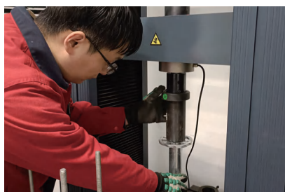
焊缝抗剪强度 检测连接花盘内侧环焊缝
