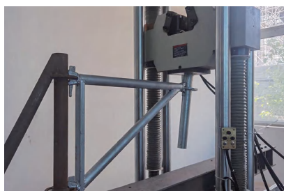
承载力测试 悬挑三角架
